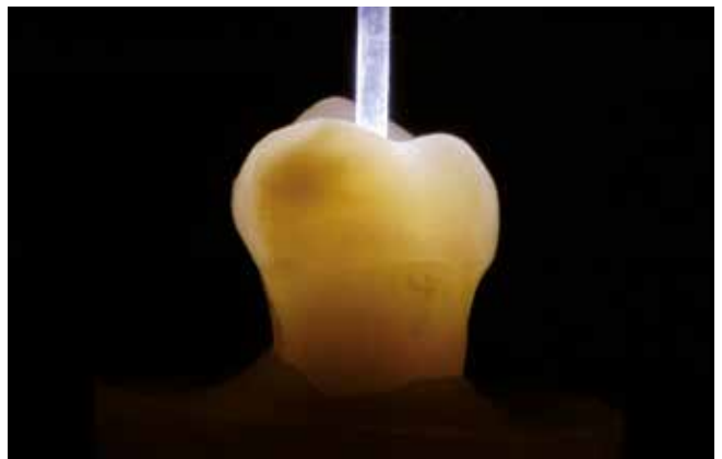
Fig. 6 - Évaluation de la présence de fêlures dans les échantillons SCSR grâce à la transillumination.
